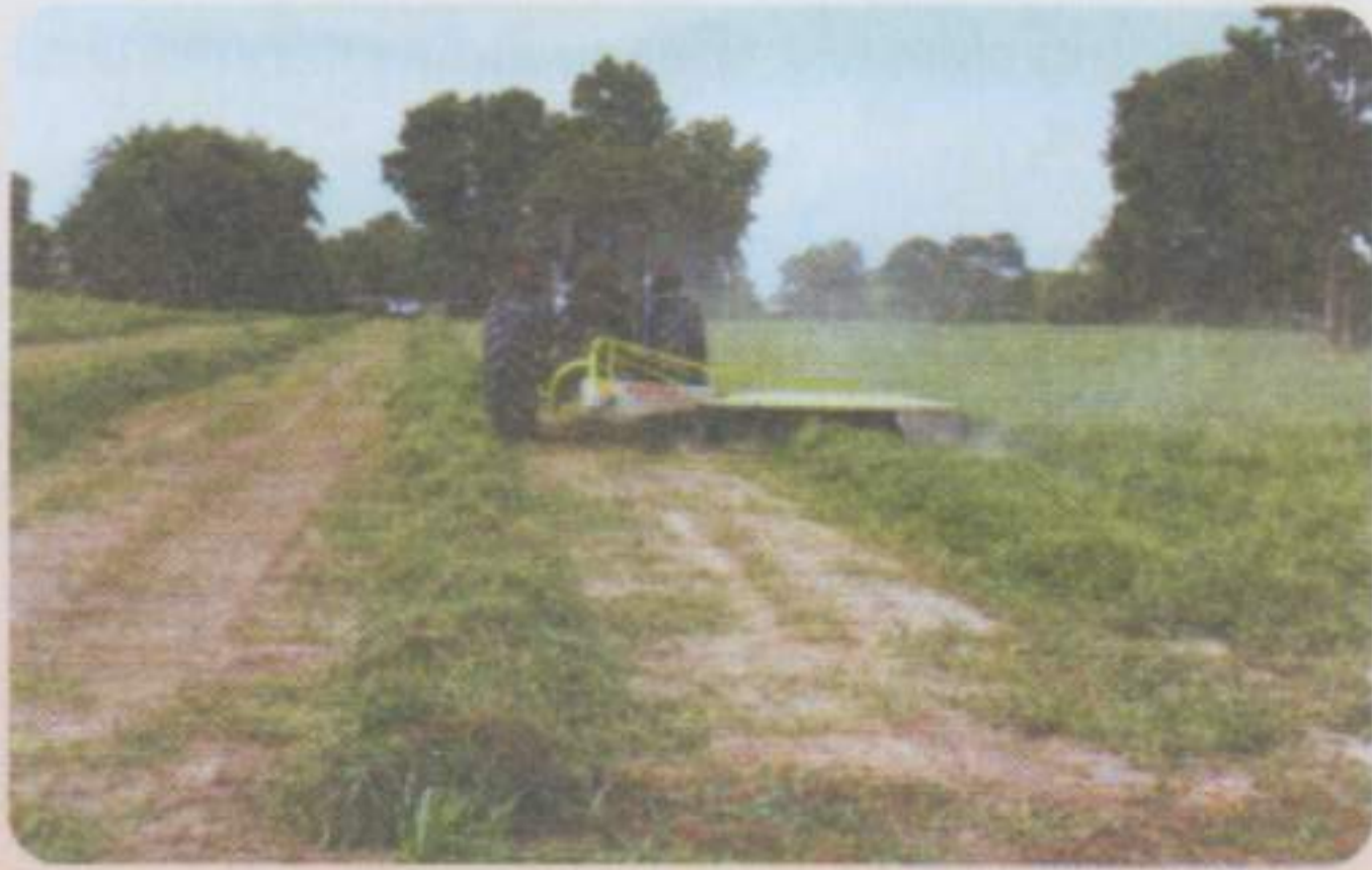
การตัดหญ้าโดยใช้เครื่องตัดหญ้าเดินพ่วงแทรกเตอร์
