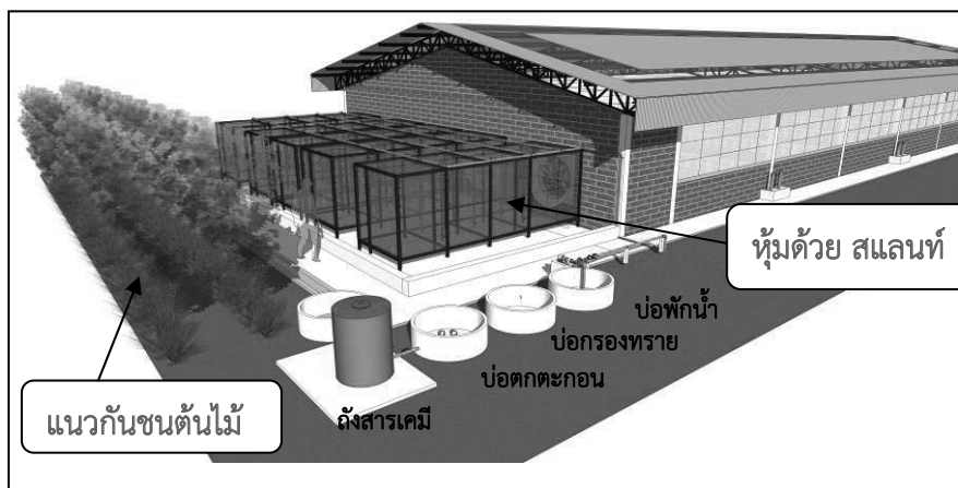
รูปที่ 7.3-8 ม่านกระจายน้ำกำจัดกลิ่นหลังพัฒนาโรงเรือน
