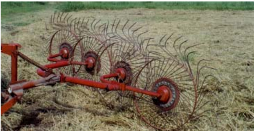
การใช้รถแทรกเตอร์ติดอุปกรณ์เกลี่ยกระจายและรวมกองหญ้า
