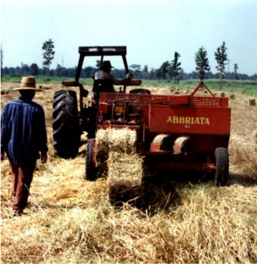
การอัดหญ้าแห้งด้วยเครื่องอัดหญ้าชนิดติดท้ายรถแทรกเตอร์
